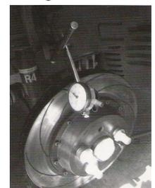
Seitenschlag der Scheibe mehr als  $\pm 0,04\text{mm}$  betragen, reinigen Sie die Nabe erneut oder ersetzen Sie die Nabe gegebenenfalls gegen ein Neuteil.
